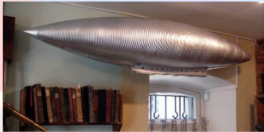
Модель оболочки аэростата из гофрированного металла
